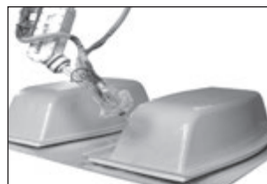
Vyztužení výlisku Zpevnění výlisku pryskyřicí s přídavkem skelného vlákna.
