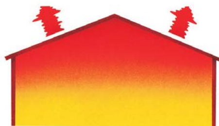
Vrstvení teplého vzduchu bez použití destratifikátoru
