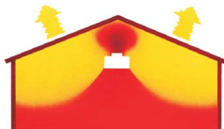
Vrstvení teplého vzduchu s použitím destratifikátoru
