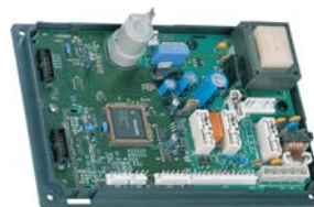
Elektronická deska již obsahuje z výroby ekvitermní regulaci
