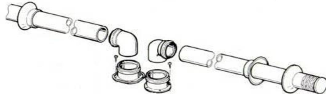
Sada děleného odkouření Ø 80/80
