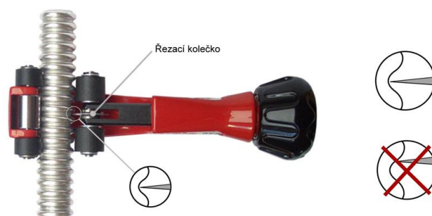
Obrázek 4 – Schéma řezání trubky
