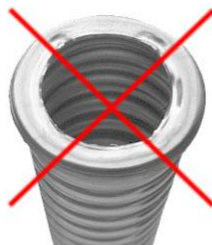
Obrázek 6 - Správné a chybné zalisování trubky
