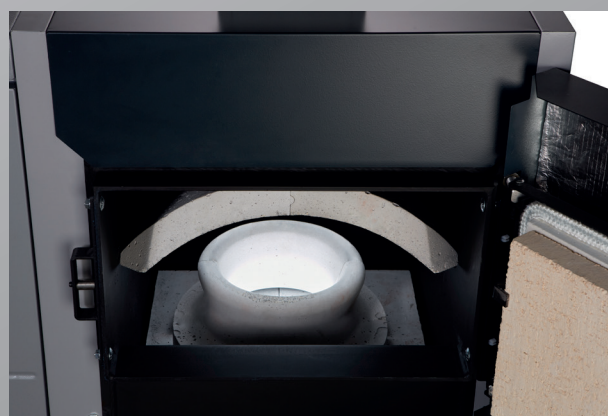
Nad litinovým hořákem je umístěna keramická tryska s rozvodem sekundárního vzduchu, ve které dochází k dopálení všech prchavých látek z paliva.
